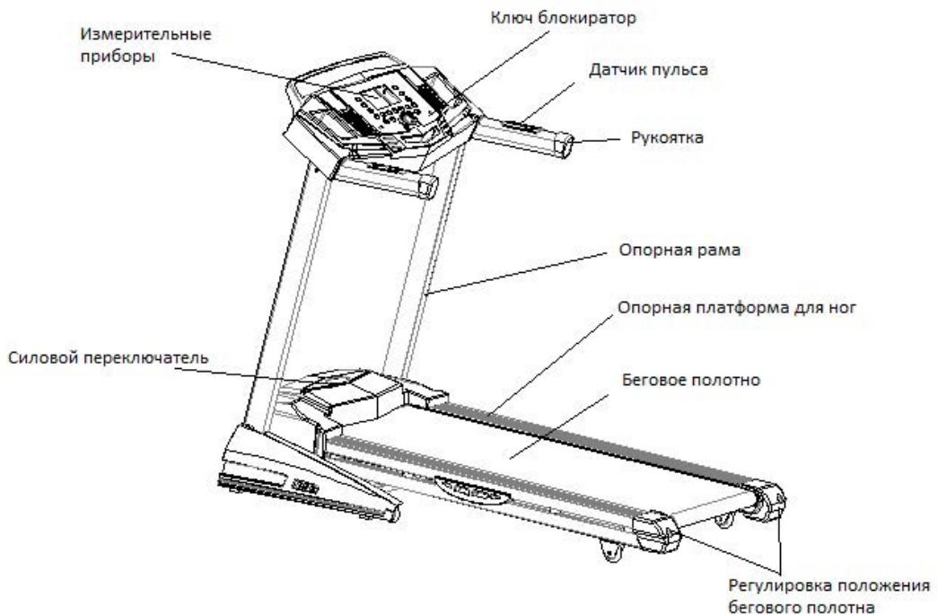
Рис.1 Электрическая беговая дорожка VF-4034
